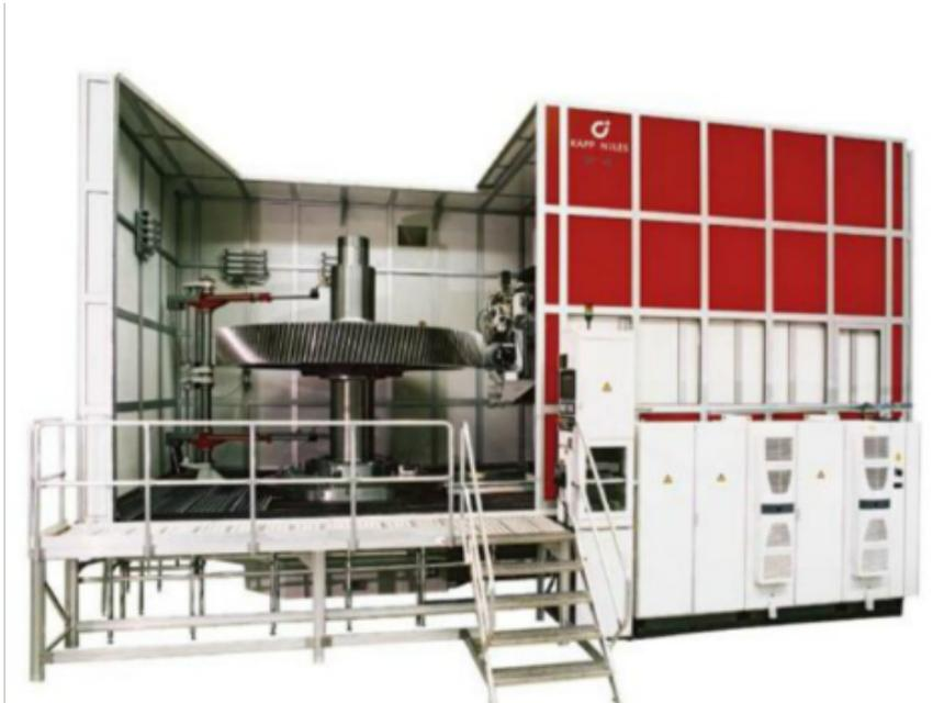
浅谈磨齿机的工作原理：蜗杆砂轮磨齿机：原理与滚齿机相似，砂轮为大直径单头蜗杆(见蜗杆传动)形状，砂轮每转一转，工件转过一齿，其传动比准确，有的用机械传动，有的用同步电动机分别驱动，有的用光栅和伺服电机传动。磨削时工件沿轴向作进给运动(见机床)，以磨出整个齿面。砂轮用金刚石车刀车削或用滚压轮滚成蜗杆形。机床为立式布局，连续分度，磨削效率高，适用于成批生产中加工中等模数的齿轮，对齿数多的齿轮尤为合适，精度可达4级。厦门纳尔磨齿机哪里有将磨削微裂纹和残余应力降低到极限，以延长数控蜗杆磨齿机砂轮的使用寿命。
